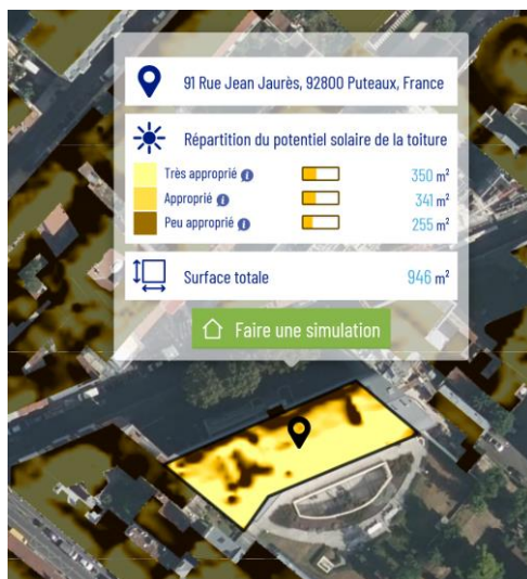
Figure 1 : Visualisation du potentiel solaire de la toiture des locaux de Paris Ouest La Défense, Immeuble Le Luminis, 91 rue Jean Jaurès, 92 800 Puteaux.
